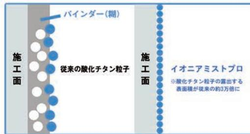
イオニアミストプロの最大の特徴は「酸化チタン粒子が自己結着する」ことです。特殊な製造技術によりチタンを超微粒子化することに成功。バインダー(糊)を一切必要とせず素材と分子間力で結合します。これにより吹き付けるだけで全面コーティングすることが可能になり、また施工面の酸化チタン粒子の表面積が圧倒的に増大し、わずかな光で酸化チタンの持つ光触媒効果を最大限発揮できます。【バインダー不要】【わずかな光で反応が起こる】従来の光触媒が抱えていた問題点・矛盾点を解消した製品こそ“イオニアミストプロ”です。
